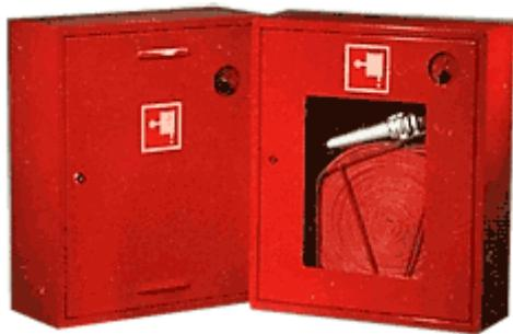
Внутренний пожарный кран представляет собой запорную арматуру, которая перекрывает воду, а при необходимости обеспечивает доступ к воде для тушения пожара. Механизм работы крана определяется видом используемого в нем запора. Так, поворотная запорная арматура позволяет отрегулировать уровень поступающей воды с предельной точностью. С помощью такого запора можно
